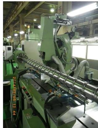
インジェクションマシン（樹脂射出成型機）の重要な構成要素で、スクリューと呼ばれている特殊軸を同時に“研磨ロボット”で自動研磨しています。2年ほど前に開発設計製作し、大手メーカーに納入しました。
