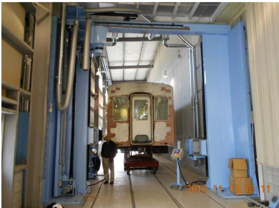
電車車両の両側面・妻面をヘアーライン加工する装置（大型洗車機状）で、地下鉄（東京メトロ他）のアルミ車両の加工用に設計製作し某車両工場に納入しました。
