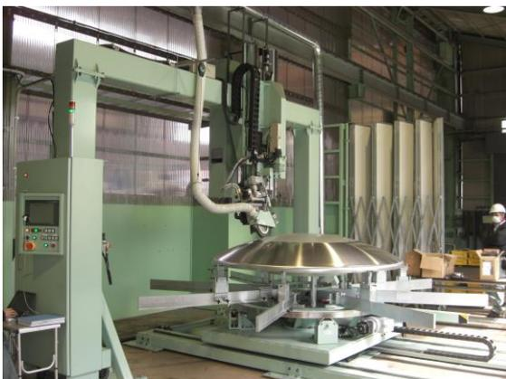
ステンレスタンクの両端部に溶接される“ステンレス鏡板”の鏡面磨き仕上げをバフを使った研磨ロボットで自動研磨しています。数年前、某大手食品ブランド製作会社に納入しました。
